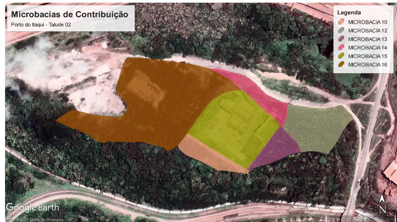
Figura 17: Definição das microbacias de contribuição superior do Talude 02
